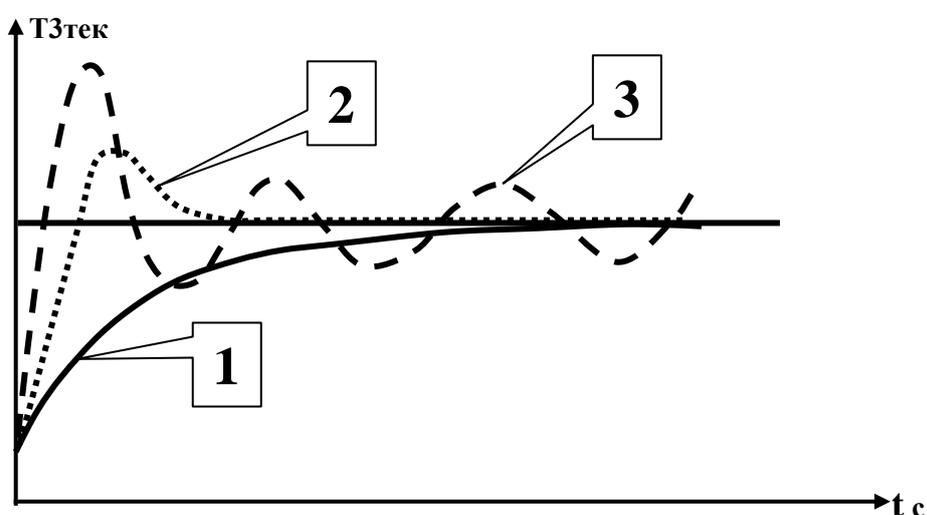
При работе регулятора после установки всех вышеуказанных настроек возможны три варианта переходных характеристик представленных на рис.4.
