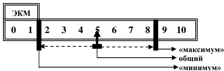
При перепаде давления воды и др. физических состояний выше настройки контакт ДЕМ - замкнут.
