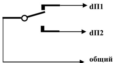
*Формирование контроля устойчивого состояния дискретного датчика с учётом «дребезга» его контакта.*
