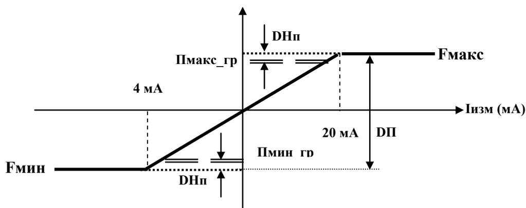
Настройка диапазона не работоспособности датчика производится установкой в процентах зоны измерения -  $\delta N_p$  относительно полного диапазона измерения -  $\Delta P$ . Значение диапазона не работоспособности вычисляется по формуле -  $\delta N_p = 100 * 2 * \Delta N_p / \Delta P$ . Значения  $\Delta N_p$  определяются в единицах измерения датчика от верхней  $P_{макс}$  и нижней  $P_{мин}$  границы полного диапазона -  $\Delta P$ .
