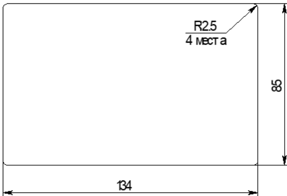
Рисунок А.6 – Размер выреза в дверце шкафа для модуля индикации ИК5 с креплением с помощью скоб, идущих в комплекте с модулем индикации
